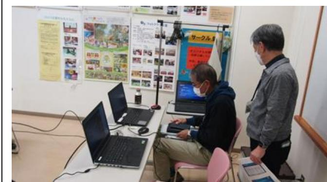
○職員の前に設置してあるPC2台の内、1台はZoom開催用のホストPC、もう1台は会場のTVモニター出力とZoom用の音声収集用に使用している。右奥にある1台は、オンライン受講生の実際に見ている画面を確認するためと、Zoom切断時の予備PCとして使用している。
